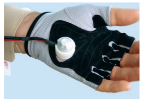
Vibro-taktile Stimulator zur Anwendung der Coordinated Reset® Therapie an Schmerzpatienten
