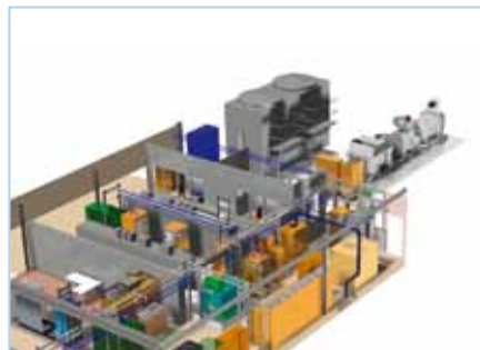
Werksabnahme-Prüfeinrichtung für Mittelspannungs-Drives im zweistelligen Megawatt-Bereich
