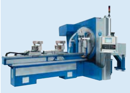
Produktionsmaschine für das vollautomatisierte Trennen von Siliziumbricks und -ingots für die Solarindustrie
