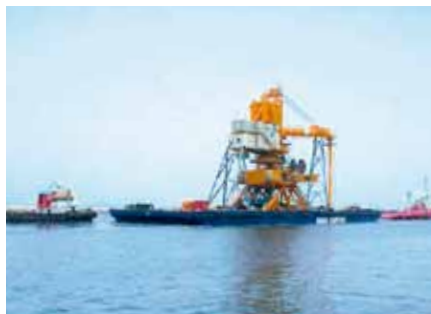
Transportstruktur eines Schiffsentladekrans in Qatar
