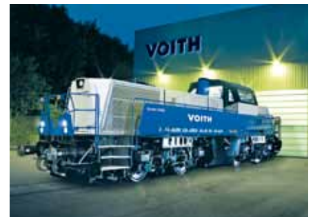
Dieselhydraulische Lokomotive Gravita® 10BB mit 1'200KW Leistung
